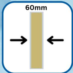
Isolation de la cellule en mousse polyuréthane expansé de 60mm d'épaisseur
